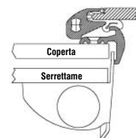
Sezione trasversale della tenda oscurante a rullo
